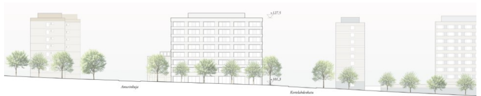
Kuva 39: Vaihtoehdossa 1 Puutarhakadun tontille osoitettu uudisrakennus toisti Kortelahdenkadun ympäristössä olevien 1960–70-luvuilla rakentuneiden lamellitalojen korkeutta, massoittelevaa ja kattomuotoa. Tontin länsi- ja pohjoisreunalla oli pienialainen asukas- ja oleskelupiha ja lisäksi piha-alueita oli osoitettu rakennuksen katolta. Puutarhakadun täydennysrakentaminen, VE1, katujulkisivu Puutarhakadulta pohjoiseen, viitesuunnitelma, AOR Arkkitehdit.
