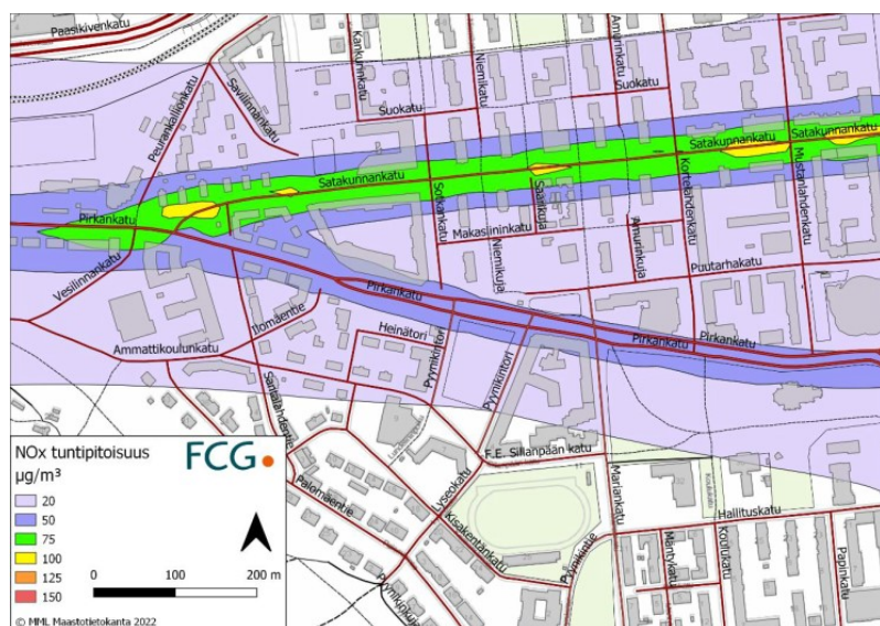
Kuva 31: Typpioksidin arvioitu suurin mahdollinen liikenteen aiheuttama tuntipitoisuus vuoden 2021 liikennemäärillä. Arvioitu taustapitoisuus 10 \mu\text{g}/\text{m}^3 ei ole mukana. Kuva: Ilmanlaatuselvitys, FCG Finnish Consulting Group Oy 2022.
