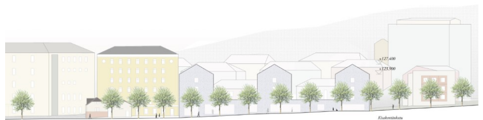
Kuva 45: Vaihtoehdossa 2 Heinäpuistoon osoitettiin rakennusmassa, joka koostuu kolmesta 4-kerroksisesta lamellista ja 1-kerroksisesta osasta Pirkankadun varrella. Rakennus sopeutui Pyynikinrinteen kaupunginosan rakennuskannan mittakaavaan. Rakennuksessa oli harjakatto ja Pirkankadun varren matalamassa osassa viherkatto, joka soveltui myös asukkaiden oleskeluun. Heinäpuiston täydennysrakentaminen, VE2, katujulkisivu Pirkankadulta etelään, viitesuunnitelma, kuva AOR Arkkitehdit.
