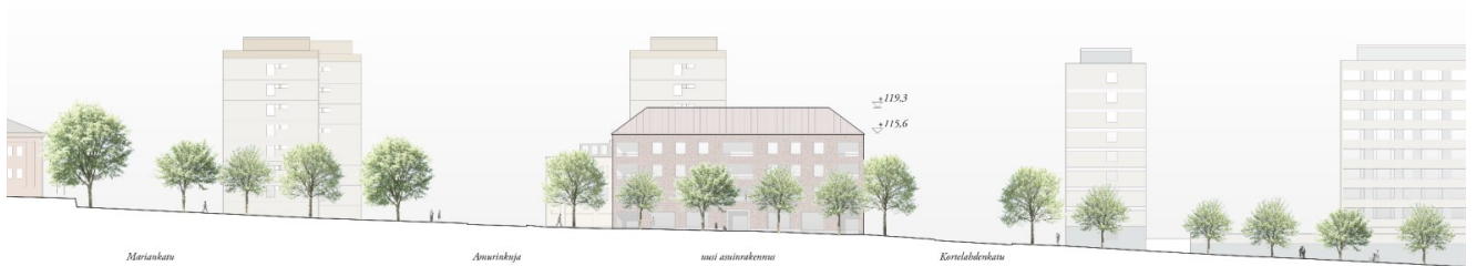
Kuva 23: Puutarhakadun täydennysrakentaminen, katujulkisivu Puutarhakadulta pohjoiseen, viitesuunnitelma. Puutarhakadun tontille osoitetaan 4-kerroksinen asuin kerrostalo, joka on kooltaan ja kattomuodoltaan samassa korttelissa olevan 1950-luvun alussa rakentuneen asuin kerrostalon mukainen. Tontin länsi- ja pohjoisreunalla on leikki- ja oleskelupiha. Kuva: AOR Arkkitehdit, 2022.
